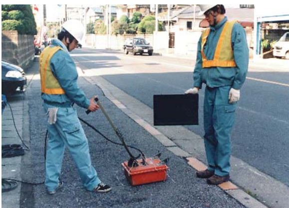
測定はアンテナを移動させるだけ。
